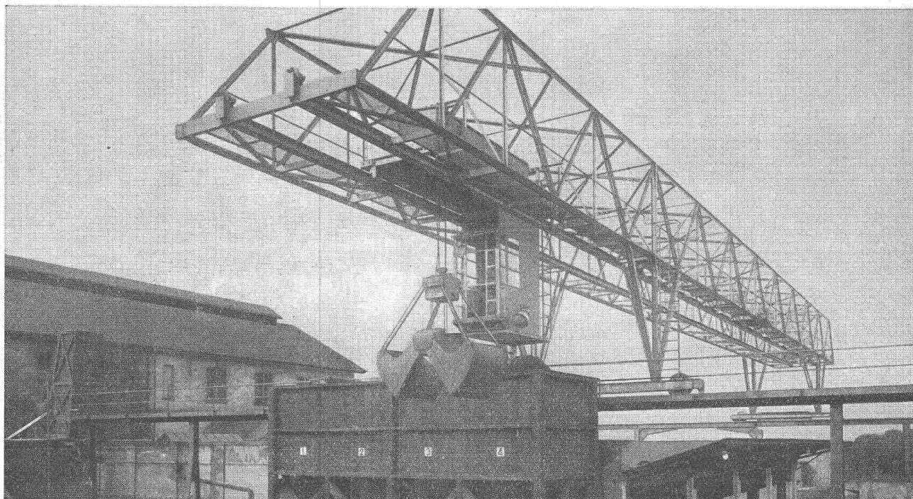
Verladebrücke in Schweisskonstruktion 2,5 t Tragkraft, 46 m Länge
