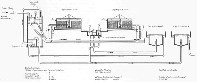
Bild 8. Schema einer Wechseltropfkörperanlage
