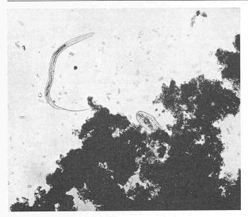
Bild 4. Biologisches Leben am Ablauf des Tropfkörpers der Anlage Bilder  $1 \div 3$
