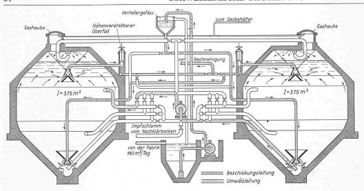
Bild 10. Faulbehälter für Hefeabwasser, Schnitt
