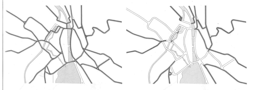
Bild 17. Strassenbahngleise in den Fahrbahnen der Innenstadt. Wegen der hohen Kosten taucht die Unterpflasterstrassenbahn schon vor den Limmat- und Sihlübergängen wieder auf. Der gleisfreie Bereich ist aber wesentlich grösser. Es kommt nicht darauf an, die Strassenbahn im Tunnel zu führen, sondern sie vom übrigen Verkehr zu trennen
