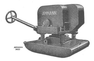
Rasches und vollständiges Verdichten von neuen Strassen, Plätzen, Flugpisten, Dämmen, Fundamenten usw.
