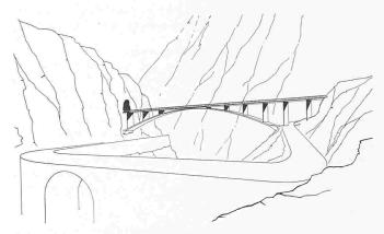
Projekt des Kantonalen Bauamtes von Uri, Kant. Ing. A. Knobel. Bearbeitung Ingenieurbureau Dipl. Ing. M. R. Ros, Zürich. Fahrbahn in vorgespanntem Beton
