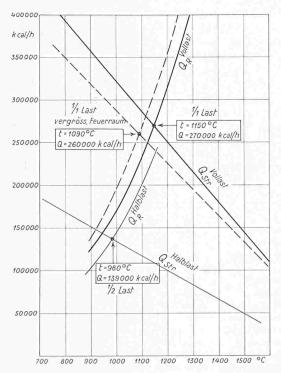
Bild 10. Graphische Bestimmung der Feuerraumtemperaturen
