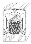
Bild 1b. Gusseiserner Schachtkessel mit unterem Abbrand
