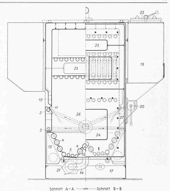
Bild 5. Querschnitt durch den Ygniskessel. Die Primärluft wird durch Düsen, die durch die wassergekühlten Rostrohre geführt sind, in den Brennstoff eingeblasen; die Sekundärluft, die den Flammenwirbel hervorruft, wird durch die Düsen oberhalb der Kohleneinläufe in scharfem Strahl zugeführt. Legende siehe unten
