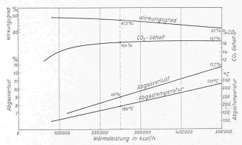
Bild 9. Betriebsversuch eines Ygniskessels von 500 000 kcal/h Normalleistung
