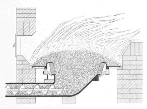
Bild 3. Mechanische Unterschubfeuerung
