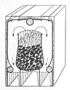
Bild 1a. Gusseiserner Schachtkessel mit oberem Abbrand
