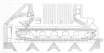
Bild 4. Mechanischer Zonenwanderrost
