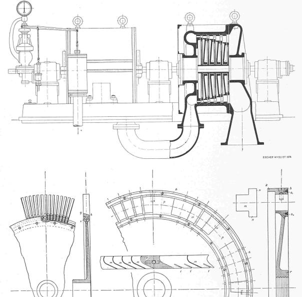
Bild 4. Einzelheiten der Turbine Bild 3. Niederdruck - Laufrad mit Befestigung der Schaufeln mittels eines aufgenieteten Kranzes. Niederdruck - Leitrad mit eingesetzten Leitschaufeln
