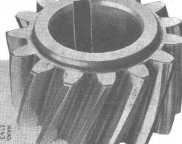
Auf MAAG-Maschine geschliffenes Traktionsritzel nach Zurücklegung von 1 040 000 km, mit spiegelglatten Zahnflanken. MAAG-Reduktionsgetriebe zwischen Dampfturbine und Kolbenkompressor, 6000 PS bei 3600/230 U/min. - Alle Verzahnungen im Einsatz gehärtet und geschliffen.
