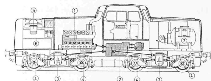
Bild 1. Kraus-Maffei-Diesellokomotive V 80 von 1000 PS mit hydraulischer Kraftübertragung und Gelenkwellenantrieb. 1 Dieselmotor, 2 hydraul. Getriebe, 3 Umschalt- und Verteilergetriebe, 4 Kegelachstriebe, 5 Kühlergruppe, 6 Treibstoffbehälter, 7 Dampfkessel für Zugheizung
