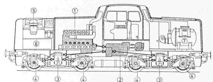
Bild 1. Kraus-Maffei-Diesellokomotive V 80 von 1000 PS mit hydraulischer Kraftübertragung und Gelenkwellenantrieb. 1 Dieselmotor, 2 hydraul. Getriebe, 3 Umschalt- und Verteilergetriebe, 4 Kegelachstriebe, 5 Kühlerrgruppe, 6 Treibstoffbehälter, 7 Dampfkessel für Zugheizung
