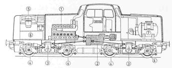
Bild 1. Kraus-Maffei-Diesellokomotive V 80 von 1000 PS mit hydraulischer Kraftübertragung und Gelenkwellenantrieb. 1 Dieselmotor, 2 hydraul. Getriebe, 3 Umschaft- und Verteilergetriebe, 4 Kegelachstrieb, 5 Kühlergruppe, 6 Treibstoffbehälter, 7 Dampfkessel für Zugheizung
