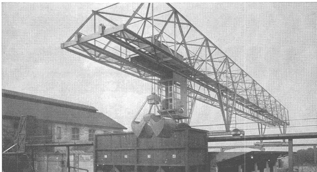
Verladebrücke in Schweisskonstruktion 2,5 t Tragkraft, 46 m Länge
