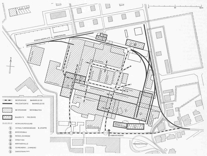
Bild 2. Grundriss der Fabrikanlage 1:2000 mit den projektierten Neubauten
