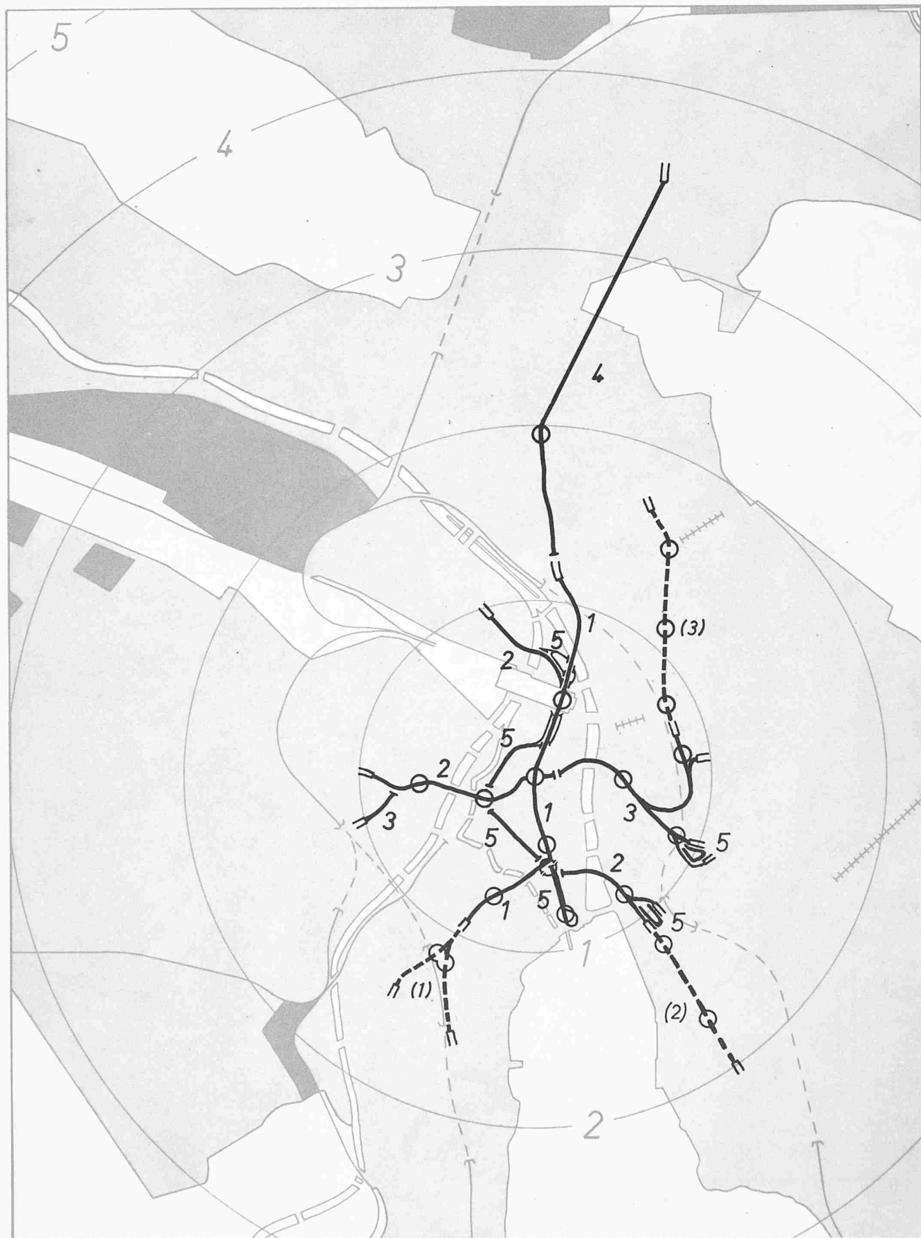
Bild 7. Ausführungsvorschlag für ein unterirdisches Schnell-Strassenbahn-System; Bauperioden
