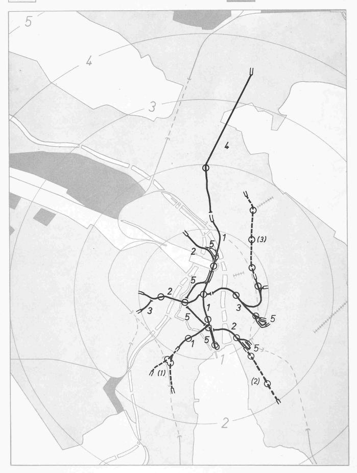
Bild 7. Ausführungsvorschlag für ein unterirdisches Schnell-Strassenbahn-System; Bauperioden
