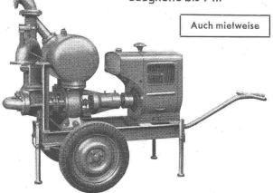
Leistungen 1-500 l/sek. Kein Bodenventil. Keine Klappe im Saugstutzen. Keine Hilfs-Vakuum-Pumpe. Jederzeitiges automatisches Ansaugen auch nach Lufteintritt im Saugrohr. Keine reibenden, sich abnützenden Dichtungsflächen, daher störungsfrei auch bei Schlamm-, Sand- und Kiesförderung.
