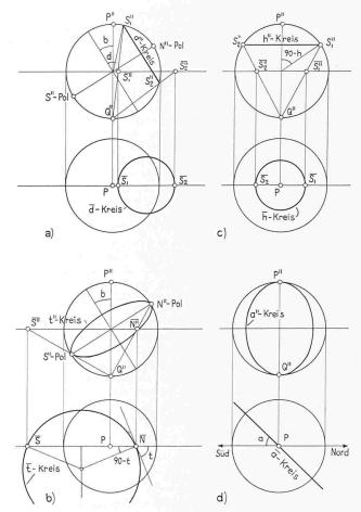
Bild 5. Stereographische Projektion der vier Kreise in Bild 1.
