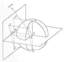
Bild 4. Stereographische Projektion von S. S'' Aufriss von S.  $\overline{S}$  Stereographische Projektion von S.  $\overline{S''}$  Aufriss der Stereographischen Projektion von S.
