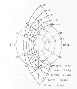
Bild 6. Diagramm der Sonnenbahn. Ablesebeispiel: Gegeben sind Datum (16. April oder 23. August) und Zeit (wahre Sonnenzeit 10 h). Aus dem Diagramm erhält man die Höhe der Sonne (h =  $40^{\circ}$ ) und deren Azimut (a =  $310^{\circ}$ , Südosten).
