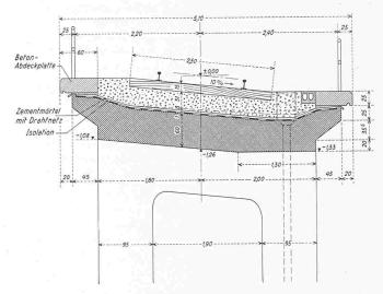
Bild 3. Querschnitt, Masstab 1:60
