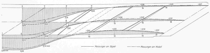
Bild 11. Gemessene Einsenkungen bei Belastung nach Bild 10, ausgezogen (gestrichelt) an der ausgeführten Brücke, strichpunktiert am Modell, auf Ausführungsmasstab umgerechnet
