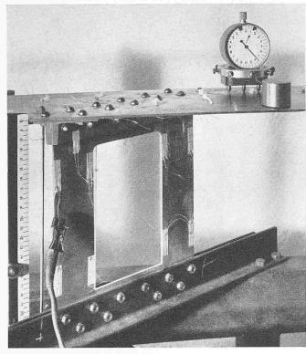
Bild 6. Einzelheit des Modells mit Pfeiler mit aufgeklebten elektrischen Dehnungsmesstreifen und Krümmungs-Messuhr
