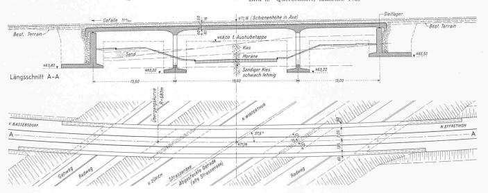
Bild 4. Längsschnitt durch die Mittelaxe und Grundriss, Masstab 1:400
