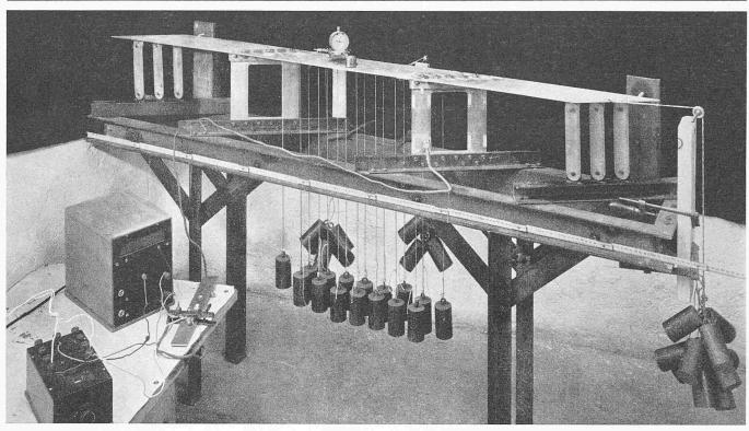
Bild 5. Ansicht des Modells mit Belastungsgewichten sowie mechanischen und elektrischen Messeinrichtungen
