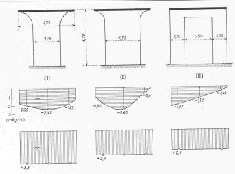
Bild 7. Die drei untersuchten Pfeilerformen, unten der Verlauf der negativen bzw. positiven Feldmomente über dem Pfeiler bzw. in Feldmitte, parallel zur Pfeileraxe
