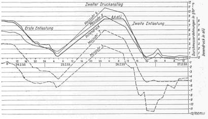
Bild 5. Dechnungsmessungen bei Km. 5,429 im Stollenprofil mit armier tem Gunit
