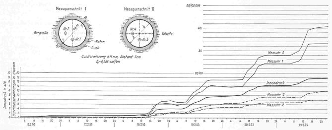
Bild 6. Dehnungsmessungen im Wasserschloss
