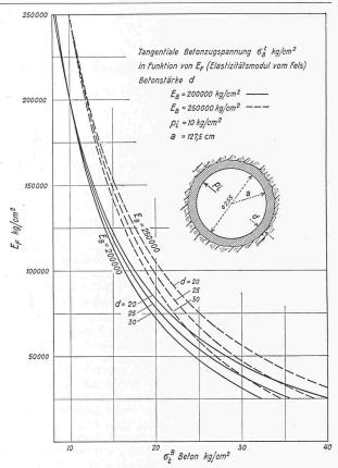
Bild 3. Tangentiale Betonzugspannung der Betonauskleidung
