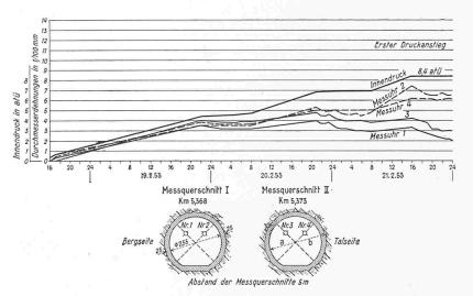
Bild 4. Dehnungsmessungen bei Km. 5,371 im Stollenprofil ohne Gunit
