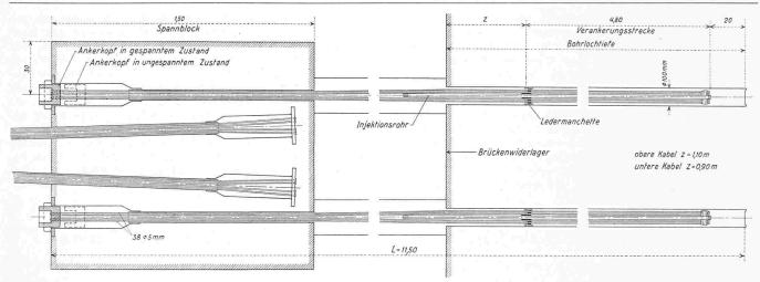
Bild 2. Horizontalschnitt 1:23 durch Spannblock und benachbartes Brückenwiderlager
