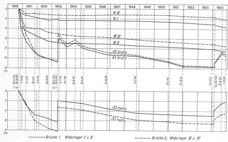
Bild 3. Oben: Gemessene vertikale Widerlager- und Scheitelbewegungen. W I Widerlager I, W II Widerlager III, W IV Widerlager IV.  $\Delta S_{brutto}$  totale gemessene Scheitelsenkungen, ausgezogen: Brücke 1, gestrichelt: Brücke 2
