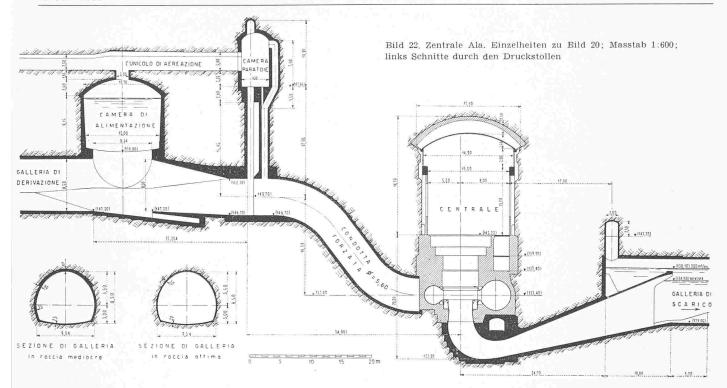
last steht, nicht ohne grosse Mehrkosten unter höheren Druck hätte gesetzt werden können. In der ringförmigen, 418 m langen oberen Kammer, die durch drei Schächte von 9,54 m Durchmesser mit dem Druckstollen in Verbindung steht, sind zwei Entlastungen von insgesamt 216 m Ueberfallänge vorhanden. Die Ueberfallkante liegt 50 cm unter dem statischen Wasserspiegel auf Kote 165,25.
