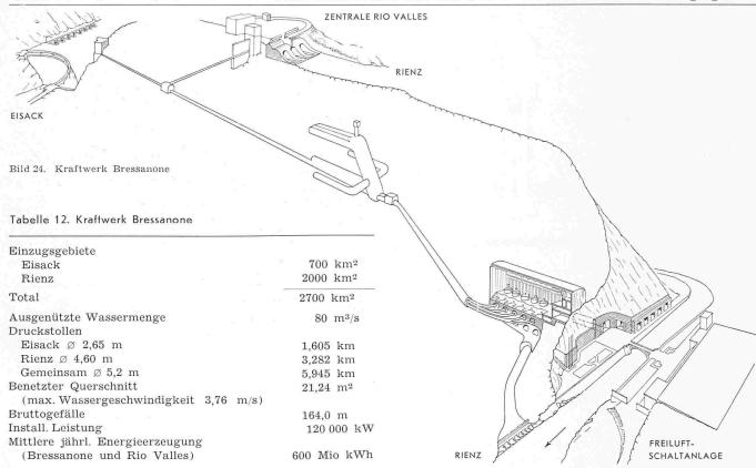
Inhalt entstand. Am Rienz bildet eine 27 m hohe Gewichtsmauer (Beton PC 200—225 kg/m³), deren Fundation sehr schwierig war, mit zwei aufgesetzten automatischen Schützen von  $15.0 \times 4.0$  m, ein Staubecken von ebenfalls 2.0 Mio m³ nutzbarem Inhalt.
