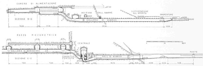
Bild 20. Wasserschloss und Zentrale Ala, Längsschnitte 1:3000
