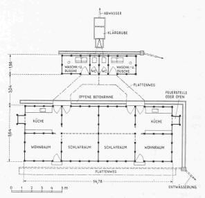
Bild 5. Grundriss einer Zweifamilieneinheit 1:250
