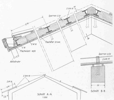
Einzelheiten der Dachkonstruktion 1:20
