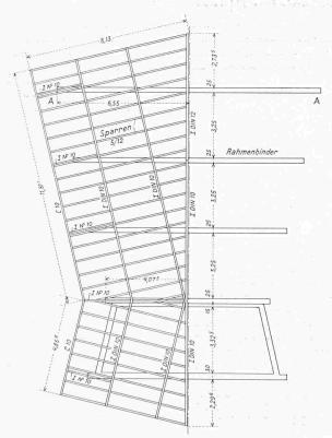
Konstruktion und Sparrenlage 1: 200
