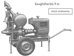
Leistungen 1—500 I/sek. Kein Bodenventil. Keine Klappe im Saugstutzen. Keine Hilfs-Vakuum-Pumpe. Jederzeitiges automatisches Ansaugen auch nach Lufteintritt im Saugrohr. Keine reibenden, sich abnützenden Dichtungsflächen, daher störungsfrei auch bei Schlamm-, Sand- und Kiestörderung.
