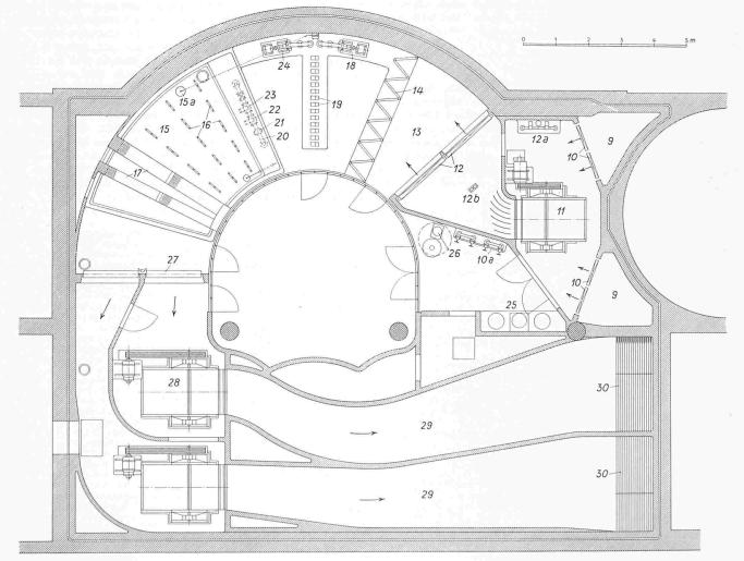
Bild 3. Grundriss der Klimazentrale auf der Höhe C - D. 1:120. Zwischen 29 und 30 ist eine Schallschluck-Vorrichtung eingebaut
