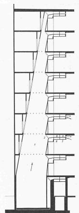
Bild 12. Vertikalschacht für Zuluft 1:200
