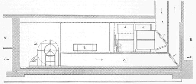
Bild 2. Schnitt durch die Zuluftkanäle, 1:120
