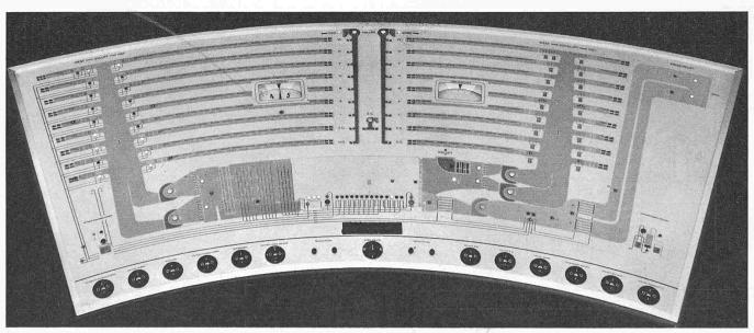
Bild 16. Tischplatte des Kommandopultes mit eingraviertem Anlage schema
