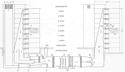
Bild 1. Prinzipschema der zentralen Klimaanlage
