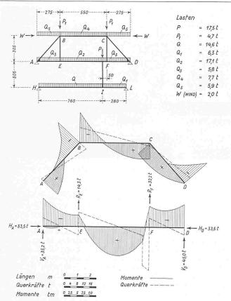
Bild 10. Belastungsschema, Momente und Querkräfte der trapezförmigen Rahmen
