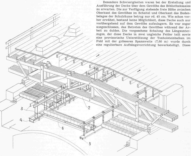
Bild 5. Installation für das Einbringen der Tonhohlsteinbalken über dem Bibliotheksgewölbe. 1 Arbeitsbühne, 2 Fachwerkträger, 3 provisorische Aufhängungen, 4 Schalung des Längsunterzuges, 5 provisorische Unterstützung der Querrippe, 6 Schiebewagen. Dieses Bild hat die umgekehrte Blickrichtung wie die Bilder 1, 2 und 4, so dass der Längsunterzug hier links der Gebäudeaxe erscheint
