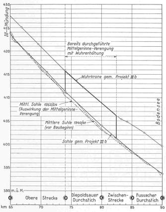
Bild 8. Sohlenlage und Höhe der Mittelgerinne - Wuhrkrone gemäss Projekt IIIb.
