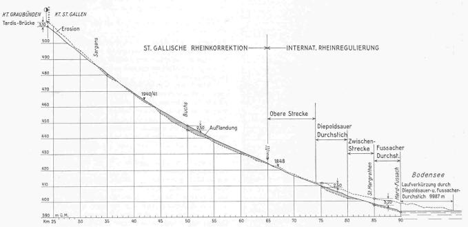
Bild 5. Rhein-Längenprofil von der Tardisbrücke bis zum Bodensee; Längen 1:450 000, Höhen 1:1600. Sohlenveränderungen von 1848 bis 1940/41.
