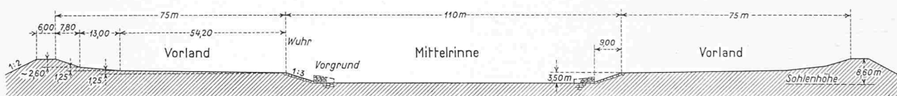
Bild 4. Querprofil 1:1700 des Diepoldsauer- und des Fussacher-Durchstichs gemäss Staatsvertrag 1892.
