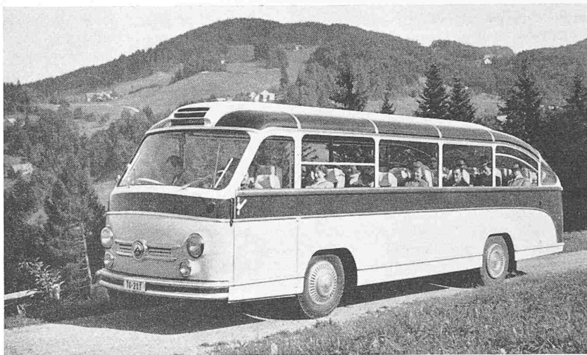
Bild 1. Reisewagen Saurer 2H. Gesamtgewicht 7600 kg, spez. Leistung 14,5 PS/t, halb-selbsttragende Karosserie
