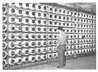
Bild 33. Schergatter mit aufgesteckten Grilon-Spinnspulen
