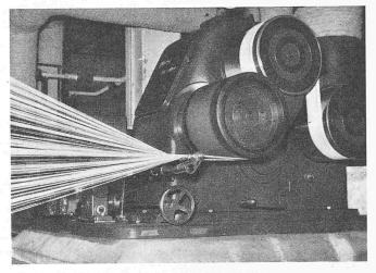
Bild 36. Strecktrio in der Grilon-Stapelfaserstrasse
