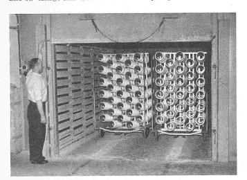
Bild 35. Trocknungsanlage für Grilon-Spinnspulen
