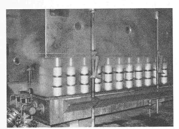
Bild 34. Anlage zum Waschen der Grilon-Spinnspulen
