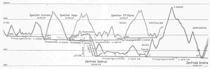
Bild 3. Kraftwerkgruppe Vorderrhein, Längenprofile der Zuflüsse aus Tavetsch und Medel und des Ausbaues bis zum Kraftwerk Sedrun. Längen 1:175 000, Höhen 1:35 000
