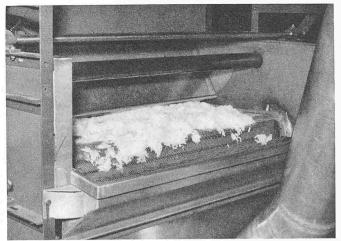
Bild 38. Teilansicht der Trocknungsanlage für Stapelfasern
