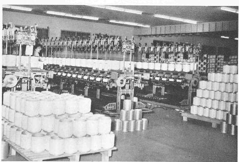
Bild 32. Teilansicht der Spinnhalle mit Spulmaschinen
