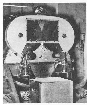
Bild 37. Schneidapparat für Stapelfasern
