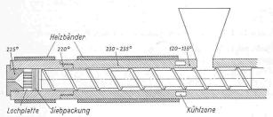
Bild 26. Schema einer Schneckenpresse für Grilon-Kunststoffe
