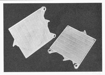
Bild 27c. Filterplatten
