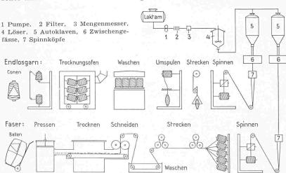
Bild 28. Fabrikationsschema für die Herstellung von Endlosgarn und Stapelfasern aus Grilon
