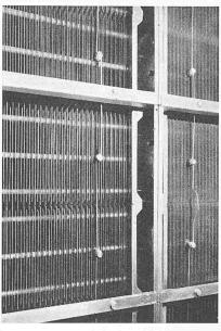
Bild 2. Abscheiderplatten eines Elektrofilters
