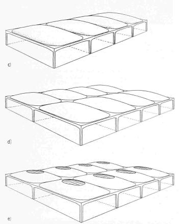
Bilder 4c, 4d, 4e. Verschiedene Kombinationen von Einzelschalen
