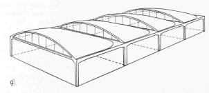
Bild 4g. Hallendach, gebildet aus in der Mitte aufgeschnittenen Einzelschalen
