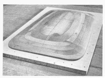
Bild 1. Hartholzmodell im Masstab 1:30
