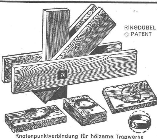
Knotenpunktverbindung für hölzerne Tragwerke
