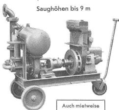
Leistungen 1—500 I/sek. Kein Bodenventil, Keine Klappe im Saugstutzen. Keine Hilfs-Vakuum-Pumpe. Jederzeitiges automatisches Ansaugen auch nach Lufteintritt im Saugrohr. Keine reibenden, sich abnützenden Dichtungsflächen, daher störungsfrei auch bei Schlamm-, Sand- und Kiestörderung.
