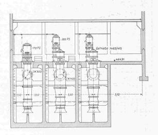
gen, wodurch ein Rückfluss von Rhonewasser in die Pumpen und den Saugsumpf unterbunden wird. — Ferner ist das Pumpwerk mit einer Handlaufkrananlage ausgerüstet, deren Tragkraft 7500 kg beträgt.
