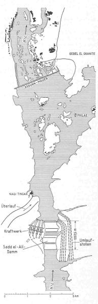
Bild 2. Die Lage des projektierten Sadd el-Ali-Dammes in bezug auf die bestehende Assuan-Staumauer (über diese siehe *E. Gruner* in SBZ Bd. 93, S. 396, 1929).
