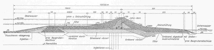
Bild 3. Sadd el-Ali-Damm, Querschnitt 1:8000. Höhenkoten in m ü. M.
