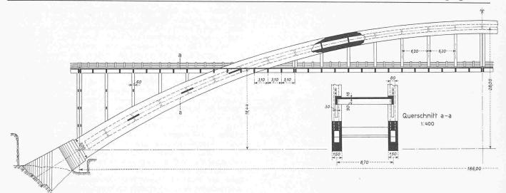
Bild 36. Brücke über den Rio das Antas, Längsschnitt 1:600
