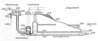
Bild 47. Kraftwerk Paulo Afonso, Längsschnitt 1:4000
