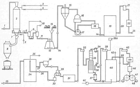
Bild 5. Prinzipschema der Holzverzuckerungsanlagen
