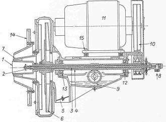
Bild 5. Rotationsbrenner für Schwerölfeuerung. 1 Zerstäuberbecher, 2 Schirm mit Oelaustritt, 3 feste Oelzuleitung, 4 rotierende Hohlwelle, 5 Luftklappe, 6 Ventilatorrad, 7 Primärluft-Konus, 8 Oelzufuhr, 9 Schneckengetriebe für Oelpumpenantrieb, 10 Keilriementrieb, 11 Elektromotor, 12 hinteres Kugellager zu 4, 13 vorderes Kugellager zu 4, 14 Flanschring zum Befestigen des Brenners an der Kesselfront, 15 Schrauben zum Spannen des Keilriemens.
