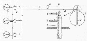
Bild 2. Prinzipschema einer Schwerölfeuerung für Heizöl III mit Ringleitung, ohne Tankheizung und Oelvorwärmer; die Oelsaugleitung wird durch warmes Rücklauföl erwärmt. 1 Rotationsölbrenner, 2 Oelfilter, 2 Oelpumpe, 4 Tank, 5 Oelzuleitung, 6 Oelrückleitung, 7 Tauchrohr als Doppelrohr, durch Oelrücklauf geheizt
