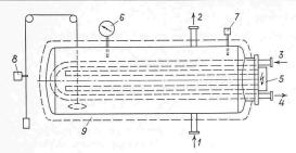
Bild 4. Heizölvorwärmer. 1 Eintritt des kalten Oels, 2 Austritt des warmen Oels, 3 Heisswasser-Vorlauf, 4 Heisswasser-Rücklauf, 5 elektrischer Heizeinsatz, 6 Oelthermometer, 7 Thermostat, 8 Schwimmerschalter für Pumpensteuerung, 9 Isolierung.
