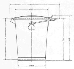
Bild 1. Abmessungen des gebräuchlichsten Ochsnerkübels Inhalt 25 1 Gewicht 4,8 kg Grösste Bügelbreite 390 mm
