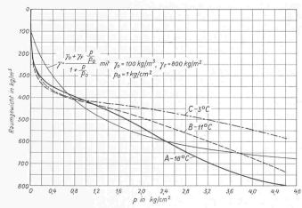
Bild 27. Verdichtung von Schnee bei verschiedenen Temperaturen
