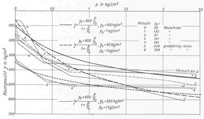
Bild 26. Verdichtung von Schnee mit verschiedenem Raumgewicht (S. L. F.)
