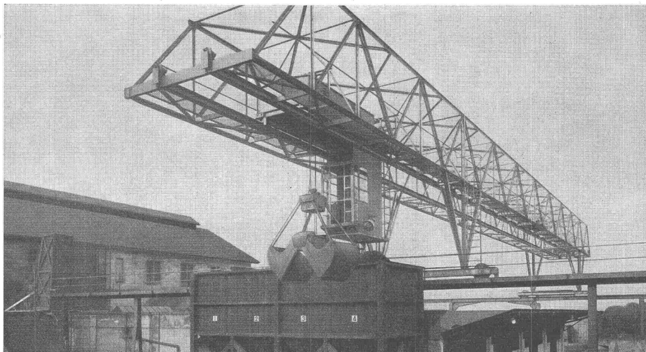
Verladebrücke in Schweisskonstruktion 2,5 t Tragkraft, 46 m Länge
