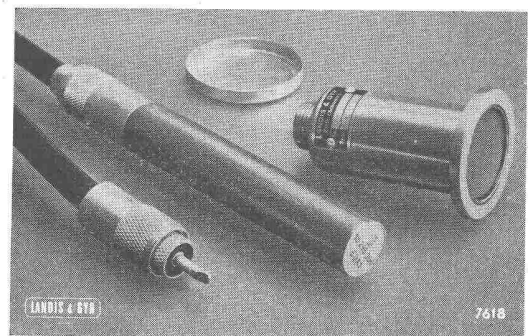
Geiger-Müller-Zählrohr für Beta- und Gamma-Strahlen.
