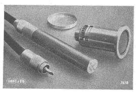
Geiger-Müller-Zählrohre für Beta- und Gamma-Strahlen.
