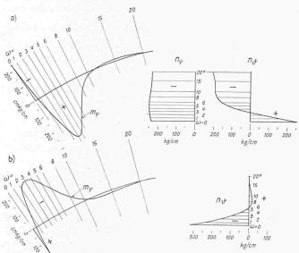
Bild 3. Verlauf der Schnittgrössen in der Behälterkuppel; a infolge Eigengewicht und Nutzlast, b infolge Vorspannung.  $m_{\varphi}$  Meridianmomente,  $n_{\varphi}$  Meridiandruckkraft,  $n_{\vartheta}$  Tangentialschnittkraft
