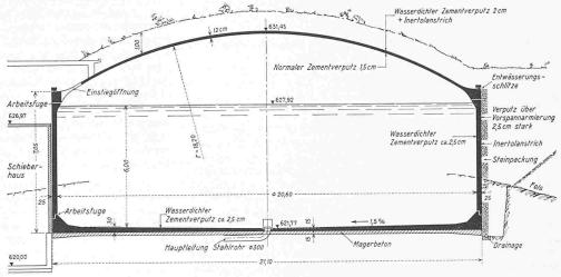
Bild 1. Querschnitt 1:200 durch den Behälter
