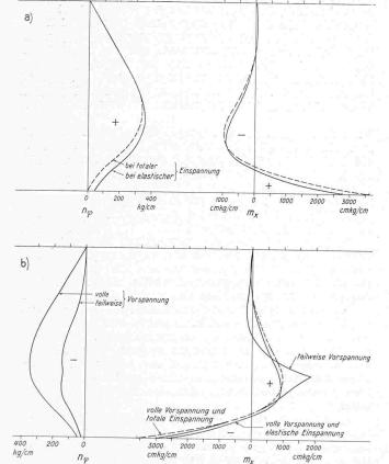
Bild 2. Verlauf der Schnittgrössen in der Behälterwand; a infolge Wasserdruck, b infolge voller und teilweiser Vorspannung.  $n_{\varphi}$  Ringzugkraft,  $m_x$  Längsmoment
