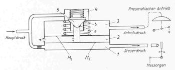
Bild 4. Prinzipschema des Verstärkerrelais. 1 untere Kammer, 2 mittlere Kammer, 3 obere Kammer, 4 Druckluftkammer, 5 Ventilkegel, a) innerer Ventilsitz, b) äusserer Ventilsitz,  $M_1$  untere Membran,  $M_2$  obere Membran
