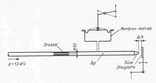
Bild 2. Grundsätzliches Schema eines Messorganes
