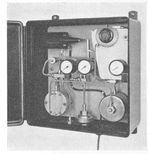
Bild 11. Temperaturfühler für Regler mit Röhrenverstärker
