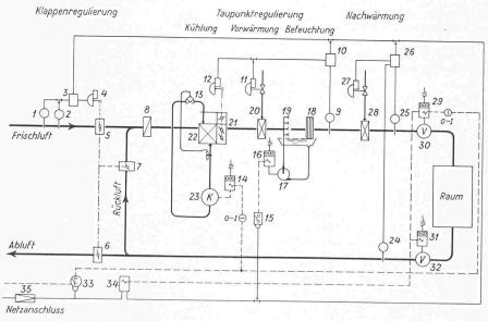
Bild 7. Prinzipschema für die pneumatische Steuerung einer Klimaanlage
