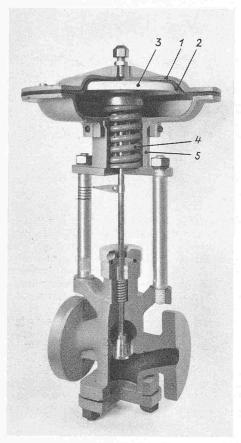
Bild 5. Membranantrieb mit angebautem Ventil. 1 Membrangehäuse, 2 Gummimembrane, 3 Membranteller, 4 Feder, 5 Federgehäuse
