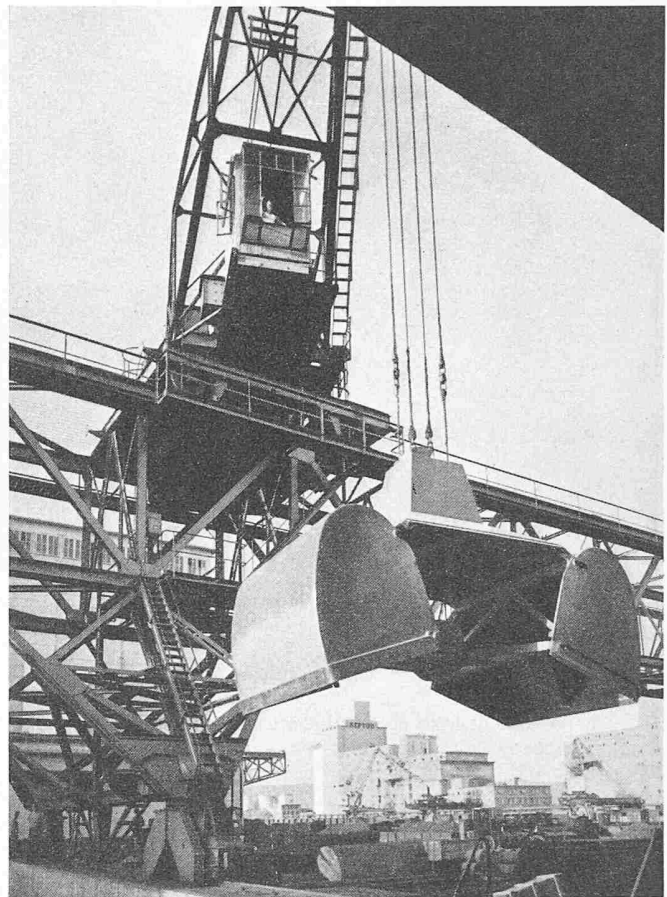
Bild 5. Detailansicht der Verladebrücke nach Bild 4, mit Getreidegreifer von 5 m³ Inhalt (+ Patent)
