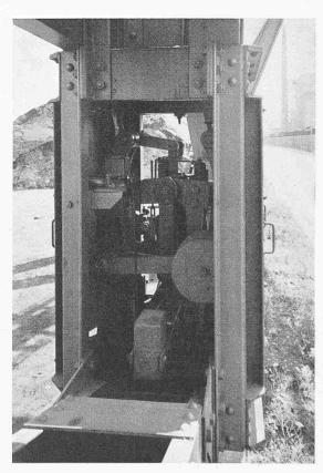
Bild 8. Windschutzbremse zu einer Verladebrücke
