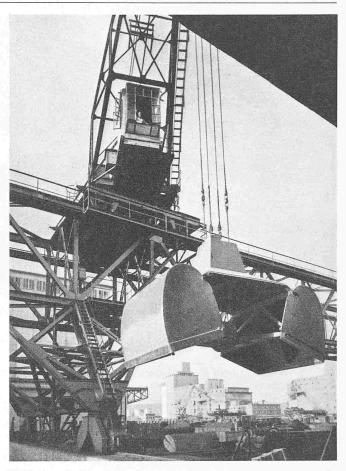
Bild 5. Detailansicht der Verladebrücke nach Bild 4, mit Getreidegreifer von  $5\,\mathrm{m}^3$  Inhalt (+ Patent)
