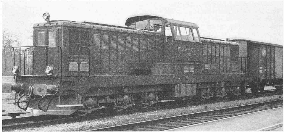
Bild 1. Dieselelektrische Lokomotive Bm 6/6 mit Güterzug
