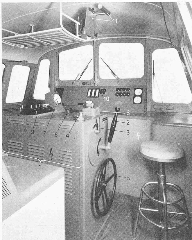
Bild 10. Führerstand der Bm 6/6-Lokomotive
