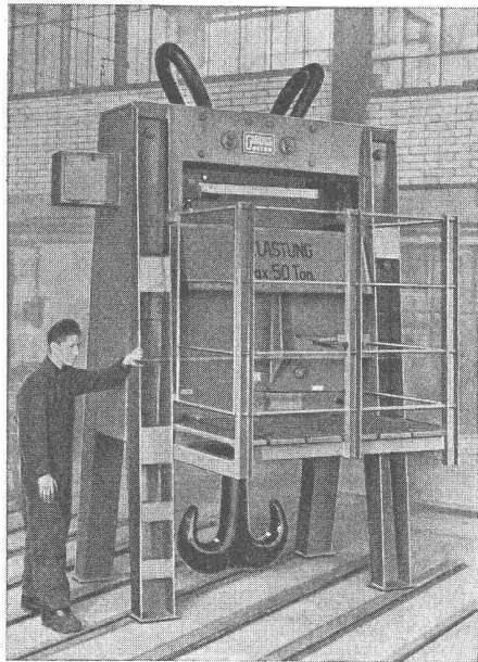
Kranwaage mit einer Wiegefähigkeit von 50 000 kg Ausführung in der bewährten Giroud-Konstruktion
