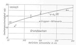
Bild 25. Geschwindigkeit von Grundlawinen als Funktion der natürlichen Scheehöhe (Auswertung der von M. Oechslin gemessenen Werte durch Ing. A. Roch, Davos)
