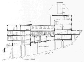
Querschnitt mit Geschossbezeichnung, 1:600
