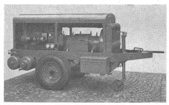
Bild 1. Luftgekühlter, fahrbarer SLM-Rotationskompressor mit luftgekühltem SLM-Dieselmotor
